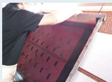
④スクージを枠の上端まで持ち上げ、一気に下ろします。
